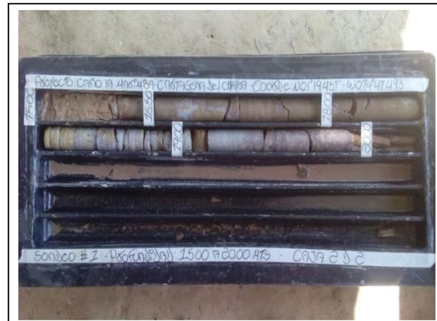
Fotografías 8.1 y 8.2 Arcillolitas varicoloreadas predominantes en el sector del proyecto de construcción de puente vial.
